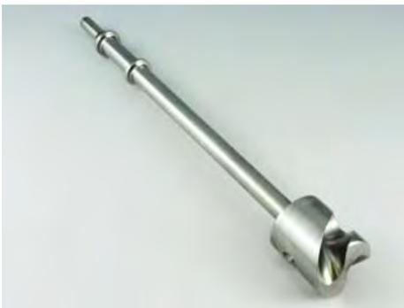
攪拌部分(アジテーター)は、家庭用ハンドミキサーは縦長の泡だて器のような形状、業務用ミキサーは強く対流を起こすスクルー形や円盤型が主流です。フロースイーツミキサーNS-01は低回転の領域で、ソフトクリームとシロップやフルーツソースを真下から吸い込み、両脇に吐き出すように特別に設計された筒型形状です。低回転数と筒型形状により、万が一回転中に指が触れても怪我をしにくくなっています。
